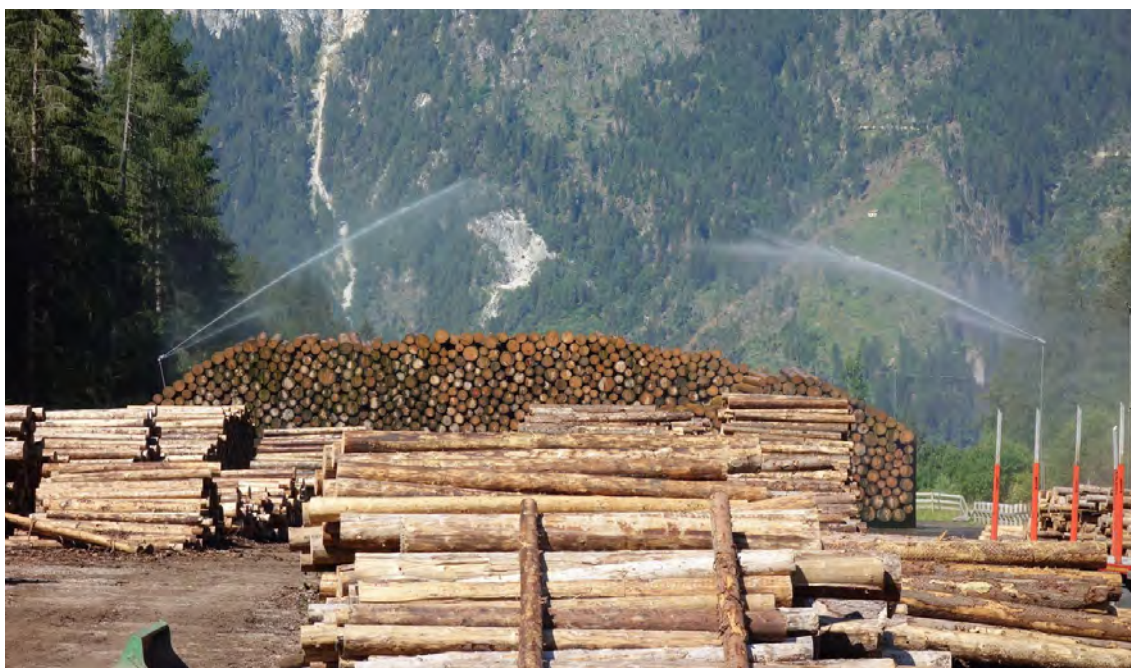
Fig.11.1 Piazzale strategico irrigato realizzato nei pressi dell'abitato di Predazzo (fonte: Ruggero Alberti - APROFOD).
