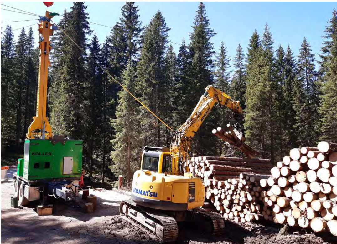
Fig.16.1 Gru a cavo ibrida nella foresta demaniale di Paneveggio (fonte: Ruggero Alberti-APROFOD).
