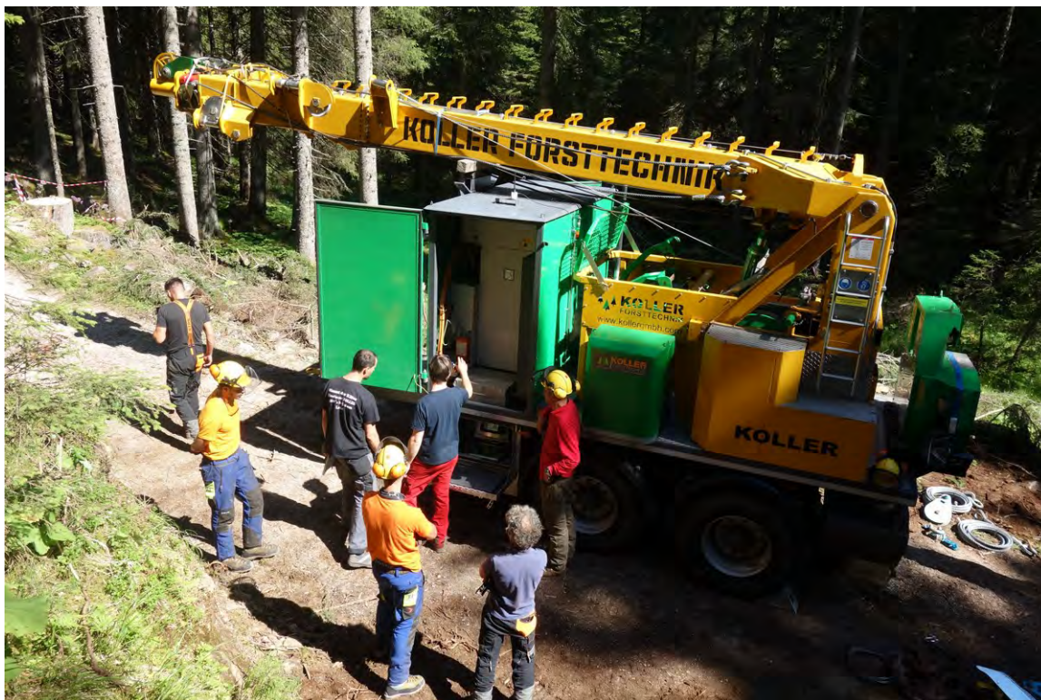
Fig.16.3 Il supercondensatore ove vien accumulato il surplus di energia prodotto nello svolgimento delle funi (fonte: Ruggero Alberti-APROFOD).
