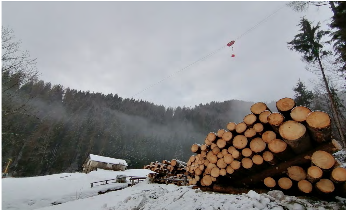
Fig. 4.3 Alcuni esempi di segnalazione di una linea di gru a cavo secondo la Normativa (fonte: Ruggero Alberti – APROFOD).
