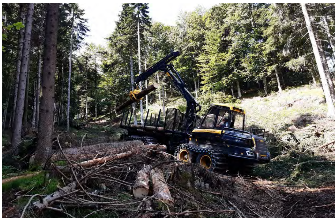
Fig. 8.3 Forwarder al lavoro in Val di Sella nel Comune di Borgo V. (fonte: Ruggero Alberti – APROFOD).
